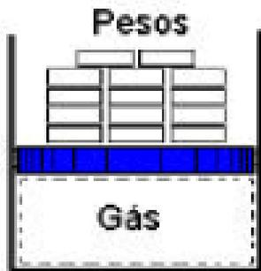
a) Calcular o trabalho realizado pelo sistema durante esse processo se for colocado um bico de Bunsen embaixo do cilindro e deixa-se que o volume do gás aumente para 0,1 m<sup>3</sup>, enquanto a pressão permanece constante.
