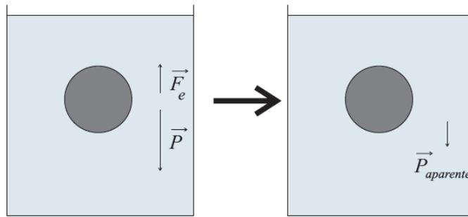
Figura 2.11 – Definição do peso aparente de um corpo mergulhado num fluido.
