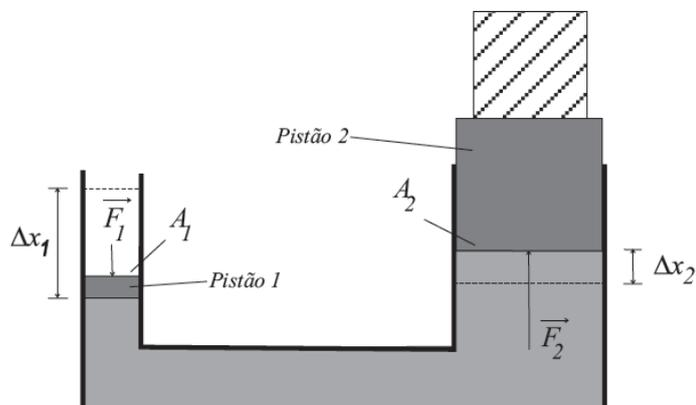
Figura 2.8 - Elevador hidráulico, o qual baseia-se no princípio de Pascal.
