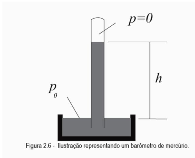
Figura 2.6 - Ilustração representando um barômetro de mercúrio.
