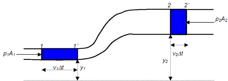
À esquerda, o tubo tem seção transversal de área  $A_1$  e à direita ele tem uma seção transversal de área  $A_2$ . À esquerda, parte inferior do tubo está a uma certa altura  $y_1$  de um certo referencial e a parte superior do tubo à direita está a uma altura  $y_2$  desse mesmo referencial.
