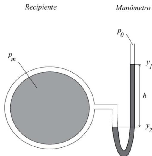
Figura 2.7 - Ilustração representando um manômetro de tubo aberto.
