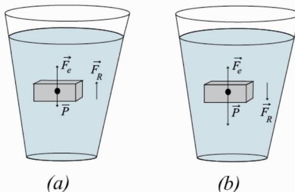
Figura 2.9 – Corpo totalmente submerso num fluido. (a) Se massa específica do corpo for menor do que a massa específica do fluido, a força resultante  $\vec{F}_R$  aponta para cima, e o corpo acelera neste sentido. (b) Porém, caso a massa específica do corpo seja maior do que a do fluido que o rodeia, a força resultante  $\vec{F}_R$  apontará para baixo e o corpo acelera nesta direção, afundando.
