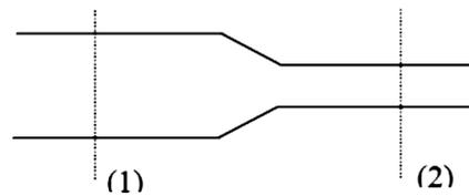
$$Q_m = \rho_1 \cdot v_1 \cdot A_1 = 0,12 \left( \frac{\text{utm}}{\text{m}^3} \right) \cdot 10 \left( \frac{\text{m}}{\text{s}} \right) \cdot 20 (\text{cm}^2) \cdot 10^{-4} \left( \frac{\text{m}^2}{\text{cm}^2} \right) = 2,4 \cdot 10^{-3} \frac{\text{utm}}{\text{s}}$$
