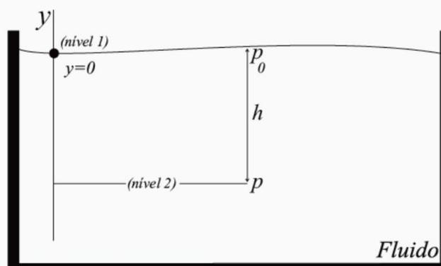
Figura 2.4 - Ilustração mostrando que a pressão  $p$  aumenta com a profundidade  $h$  abaixo da superfície do fluido, de acordo com a eq. (2.4).
