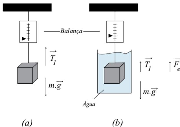
Figura 2.10 – (a) Bloco de alumínio suspenso por um fio fino e (b) mergulhado completamente num reservatório com água, sendo a determinação da sua massa feita através da balança indicada na figura.
