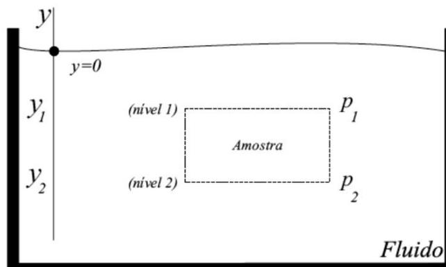
Figura 2.3 - Tanque contendo um fluido em equilíbrio estático e uma amostra qualquer imersa neste fluido. O eixo vertical  $y$  serve de referência.
