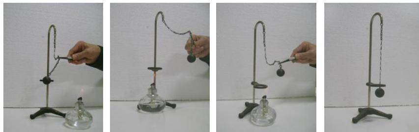
Figura 6 – A seqüência de fotografias mostra que quando o anel é aquecido ele se dilata, aumentando o diâmetro interno. Como consequência do aumento do diâmetro a esfera passa por ele.
