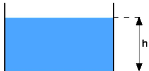
Onde  $d$  é a densidade do líquido,  $g$  é a aceleração da gravidade e  $h$  é a altura da coluna de líquido.
